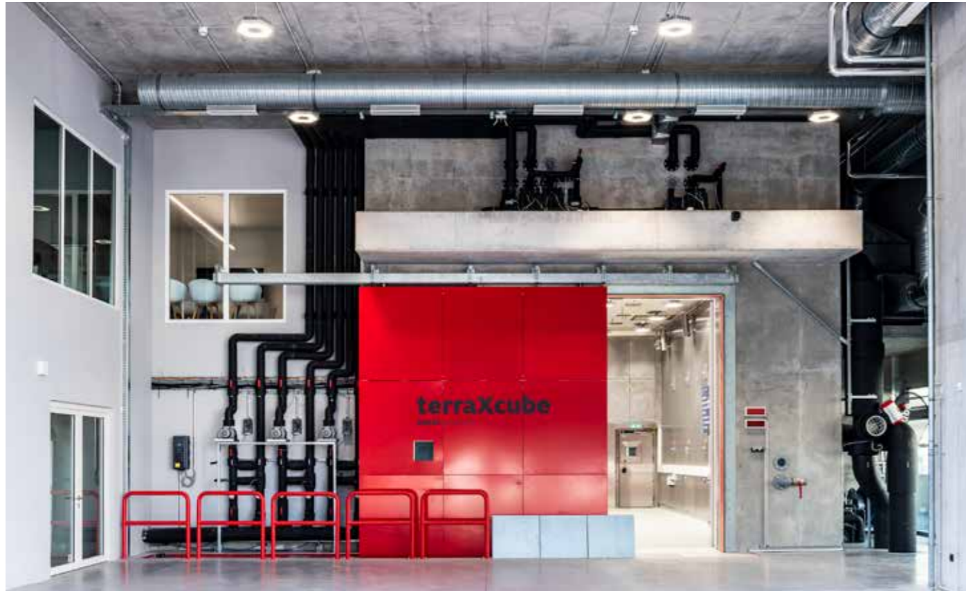
Unterdrucktore ausgelegt für bis zu 0.7 bar Vacuum gates designed for up to 0.7 bar
